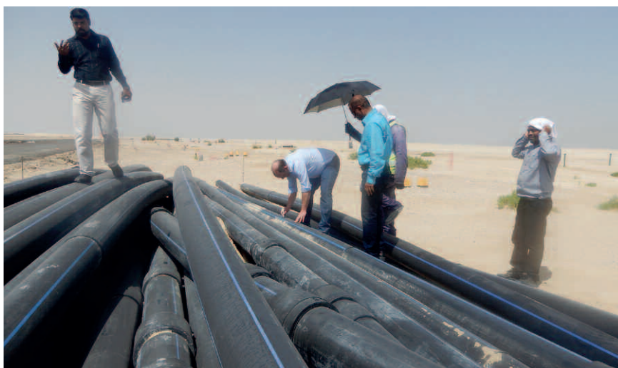
Probeentnahme in Abu Dhabi: Das SKZ prüft seit mehr als 50 Jahren den Zustand von Rohren (Foto: Ulli Eisenhut, SKZ)
