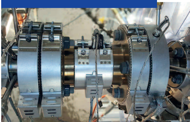
Promix Messmodul mit Druck- und Temperatursensoren
